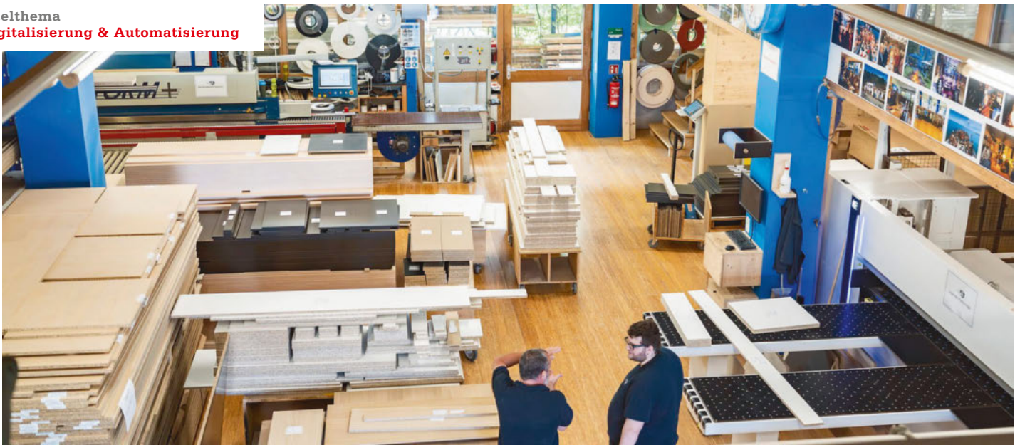
/ Hohe Produktivität auf kompaktem Raum: Rechts die Homag-Plattenaufteilsäge mit Barbaric-Beschicker, hinten links die Kantenanleimmaschine Storm+ von Ott mit automatischer Rückführung. Gut zu sehen: In der Werkstatt sind jede Menge Teile im Umlauf. Sämtliche Workflows sind datentechnisch exakt definiert.
